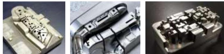
細溝加工（放電加工レス）
